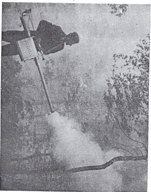
Фиг. 39. Ръчен аерозолен генератор в действие
