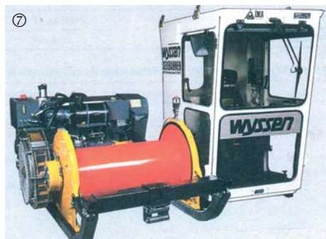
Съвременна лебедка за дългометражна въжена линия, система „Висен“, съоръжена с работна кабина
